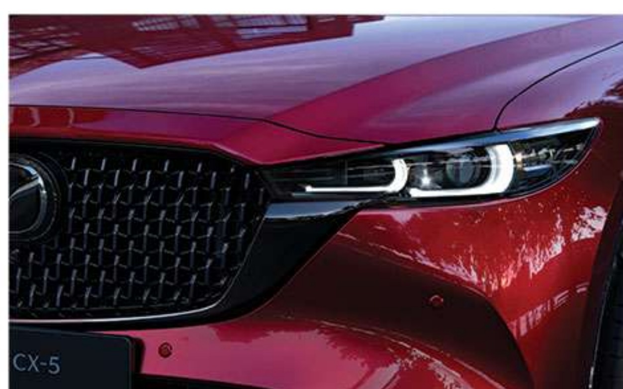
Système d'éclairage Avant Adaptatif À LED et Feux de Jour À LED (DRL)
